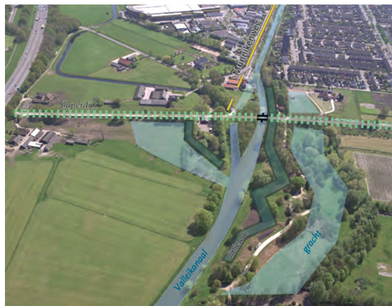
Het Werk aan de Roode Haan met de getenailleerde liniewal langs het Valleikanaal en de Slaperdijk uit 1653.
