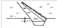
relatief diepe ontwatering met kleiige (minder zwarte) grond zichtbaar in de taluds
