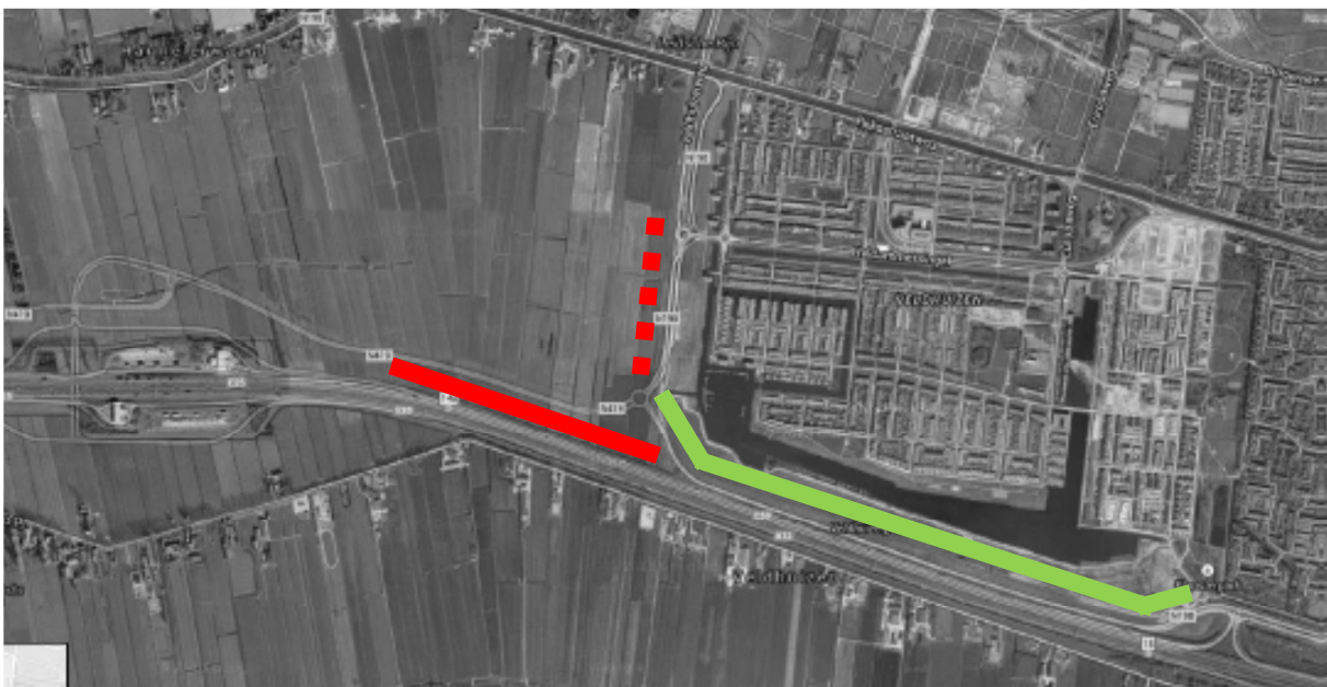
Figuur 1: Situering geluidswal Veldhuizen (groen = reeds bestaande geluidswal, rood = nieuw te realiseren geluidswal, rood gestippeld = alternatieve variant voor te realiseren geluidswal)
