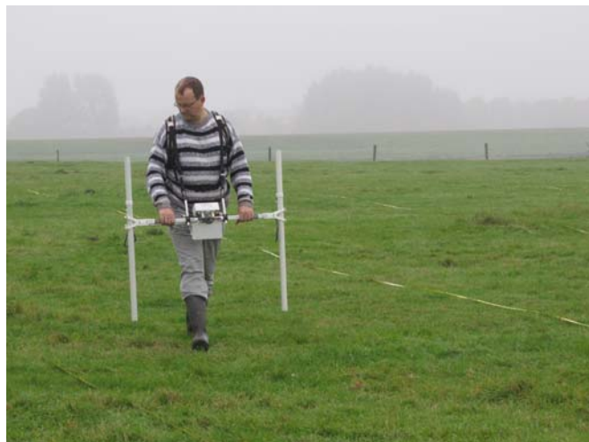
Figuur 4: Het verrichten van magneto-metingen met de Bartington Grad601 magnetometer.
