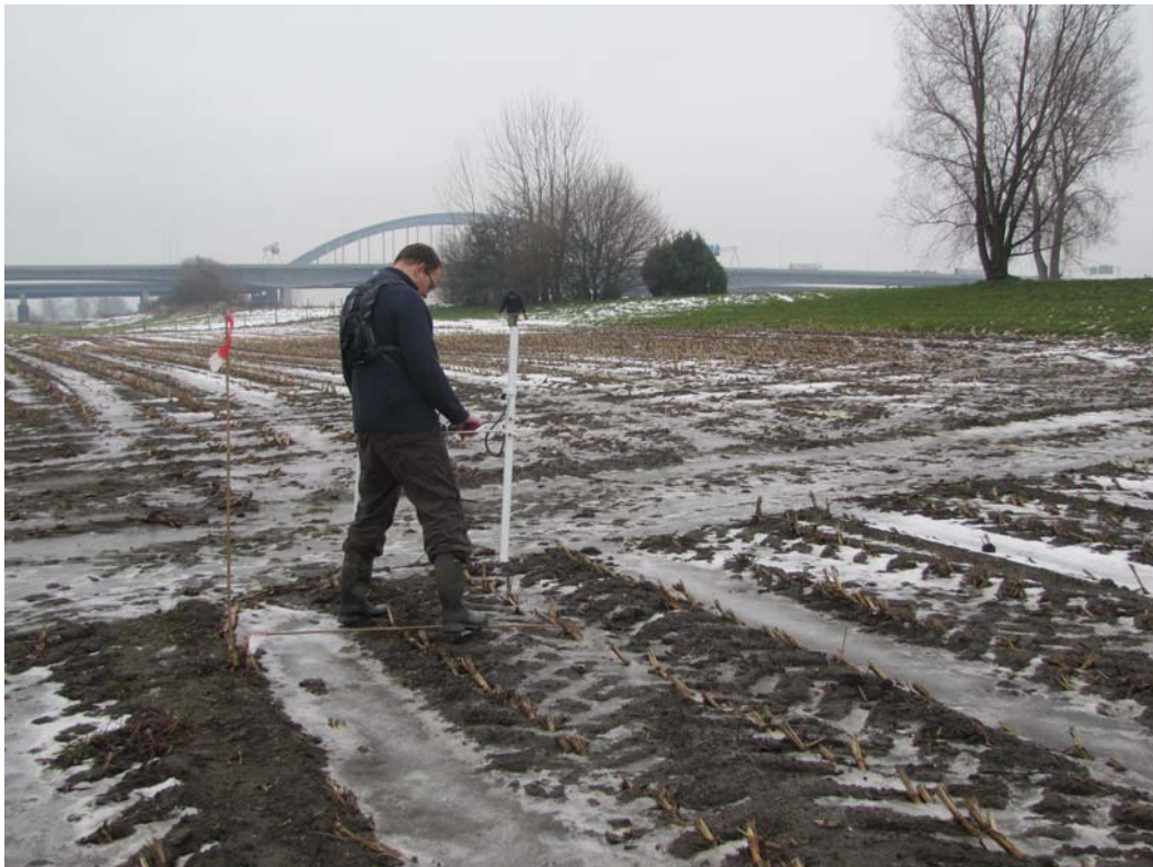
Figuur 3: Het verrichten van magneto-metingen met de Bartington Grad601 magnetometer.
