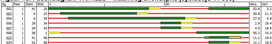
Figuur 13: Fasendiagram VRI N226 – Maanweg avondspits (cyclustijd 44 sec)
