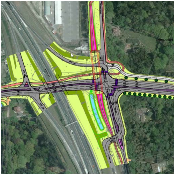
Figuur 4 Toekomstige locatie waterbergingsvijver waarin extra compensatie Hertekop is opgenomen (status plaatje onbekend)
