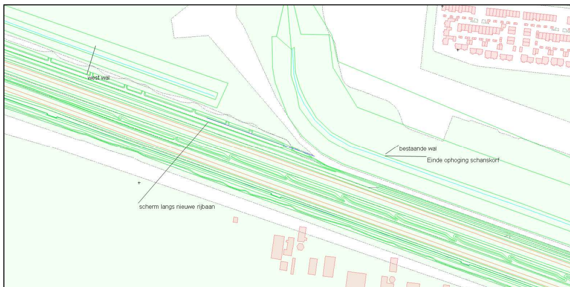
Figuur 7 : Inzicht in ophoging westelijke kop bestaande wal en positionering tussenscherm
